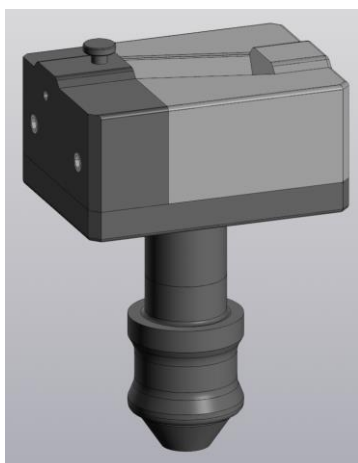
Рис. 4. Оснастка для закрепления заготовки
