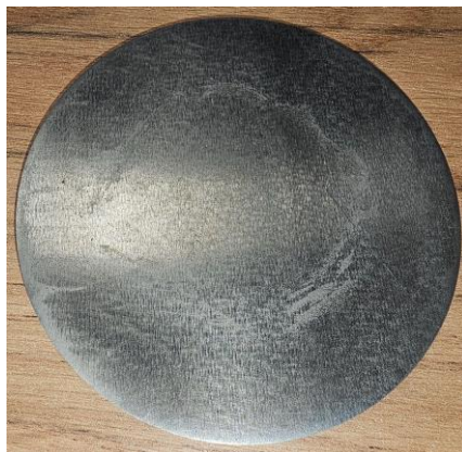
Рис. 1. Мишень «3-1-2», полученная методом СВС и подготовленная к установке в магнетрон
