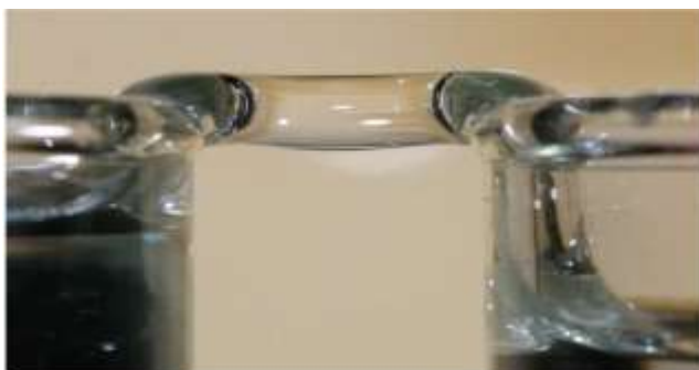
Рис. 1. Водный мостик между стеклянными стаканами на расстоянии 1 см при напряжении между электродами 15 кВ.
