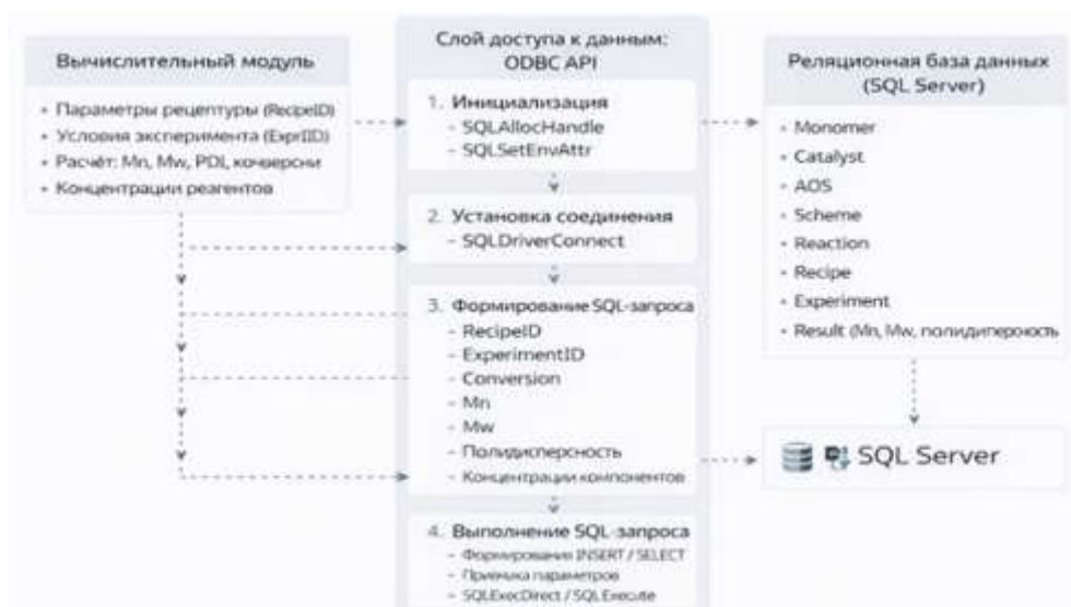
Рис. 3. Схема взаимодействия с базой данных через ODBC API.
